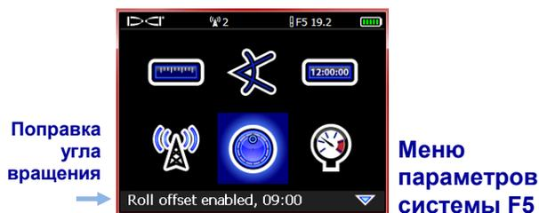
Для установки поправки угла вращения в приложении, нажмите или перетащите указатель угла вращения и нажмите на **Старт**. Снова нажмите на кнопку **Старт** на экране 10-2-7, поверните зонд в течение выделенного времени на мигающую синюю полосу в положении на 10:00 часов и подождите пока система не покажет соответствующие инструкции.
